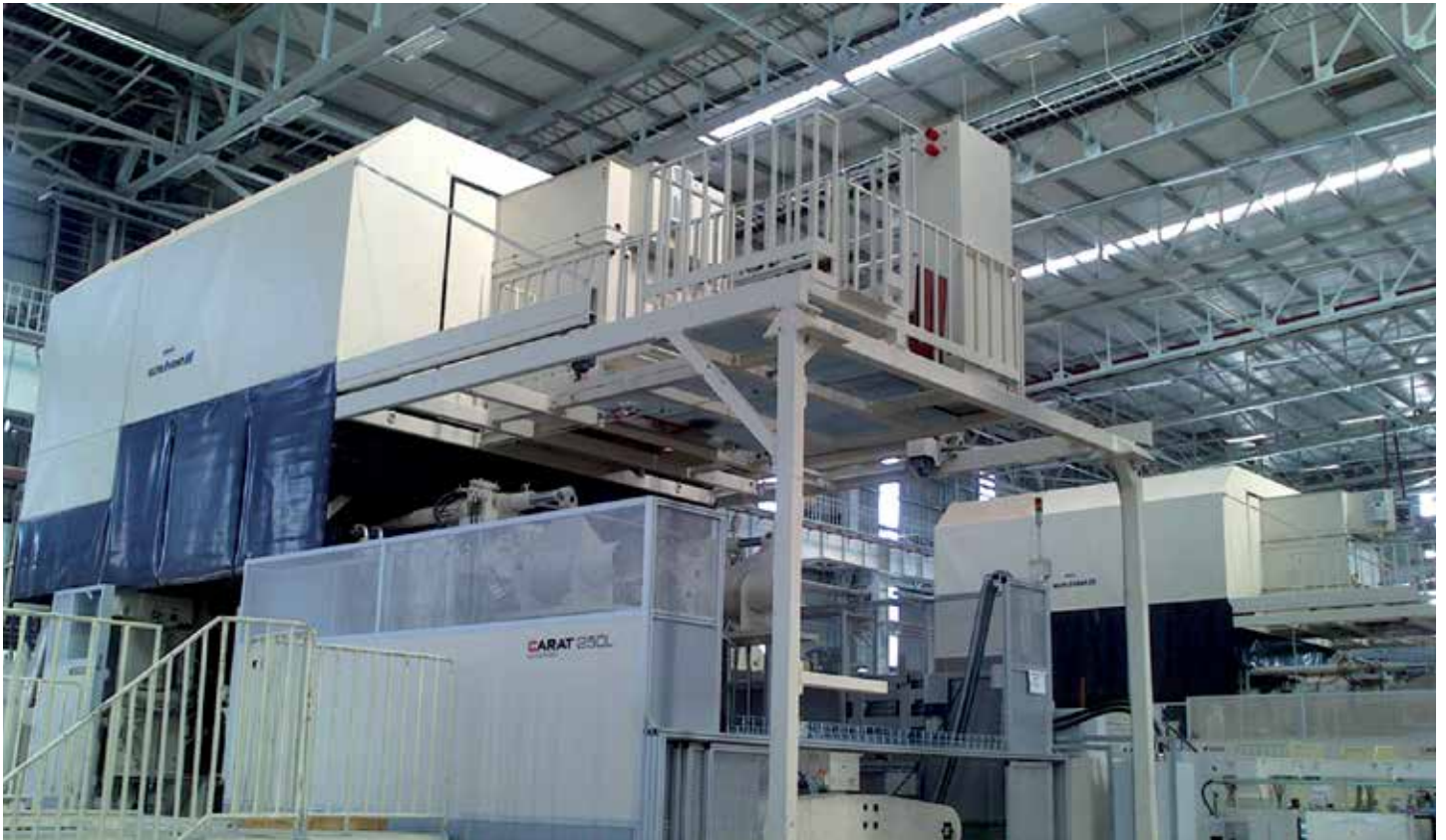
Машины Bühler оборудованы децентрализованными фильтрационными системами для отработанного воздуха KMA ULTRAVENT. Здесь экономия энергозатрат достигает почти 80 %.
