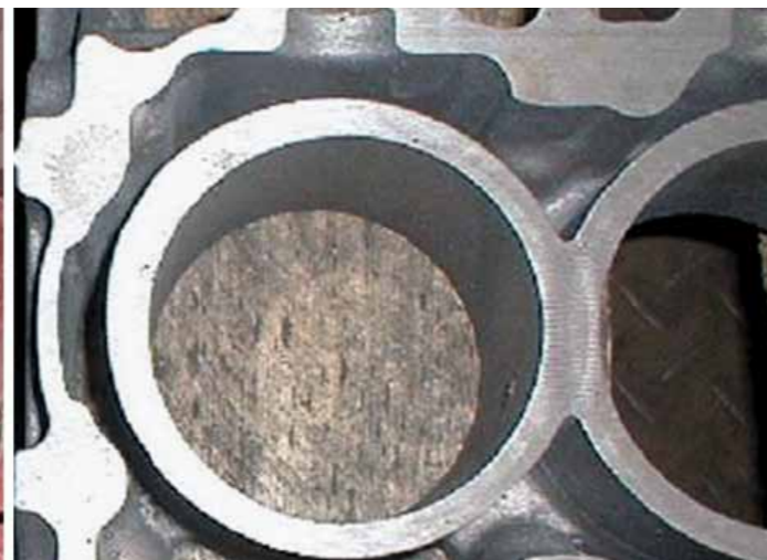
شکل 7: ماهیچه مجاری آب با پوشش RHEOTEC XL و سطح داخلی عاری از نقیصه
