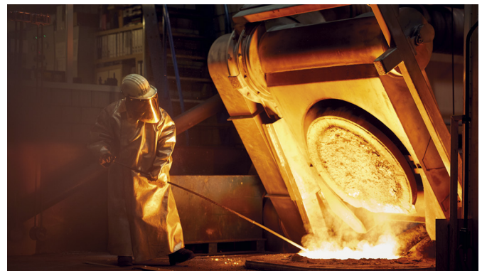
Deslagging of the liquid cast iron Dökme demirin cürufunun giderilmesi
