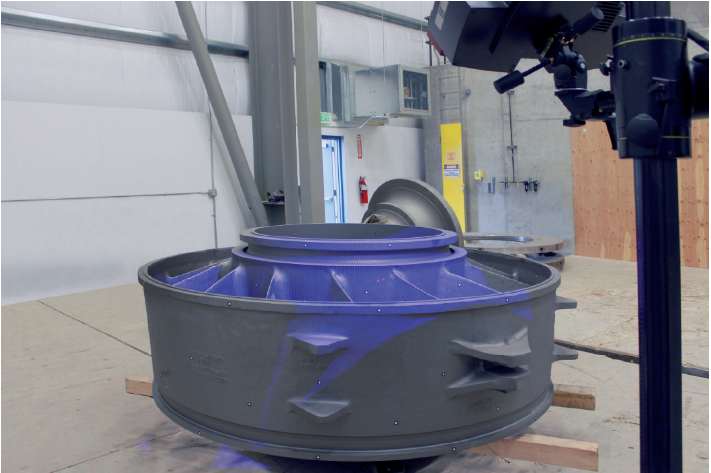
Рис. 3: Технология „Blue Light“ (рис. 3). За счет узкого диапазона синего света проектора, система выполняет точные измерения независимо от окружающих условий освещения и сканирует блестящие поверхности.
