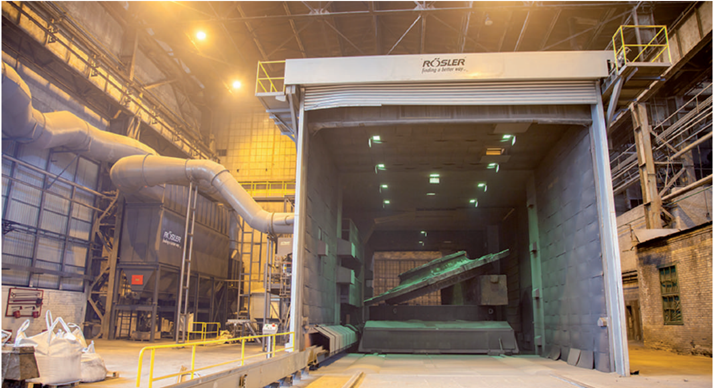
Крупнейшая установка производства Rösler рассчитана на заготовки габаритами 12 000 x 7000 x 5000 мм (Д x Ш x В) и массой макс. 250 тонн.
