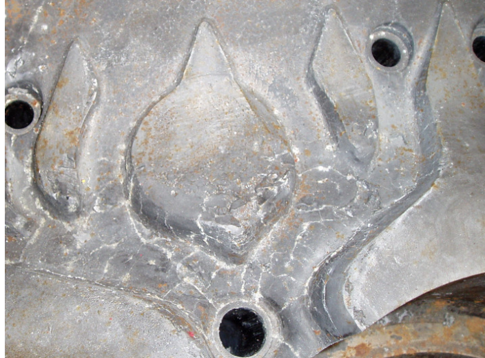
Abb. 1: Brandrissnetzwerk an der Oberfläche eines Druckgusswerkzeuges nach ca. 110.000 Zyklen.
