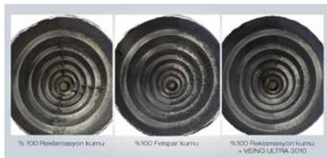
Şekil 4: Veino ULTRATM 3010 kullanarak yüzey kalitesinin iyileştirilmesi, yarı boyanmış
