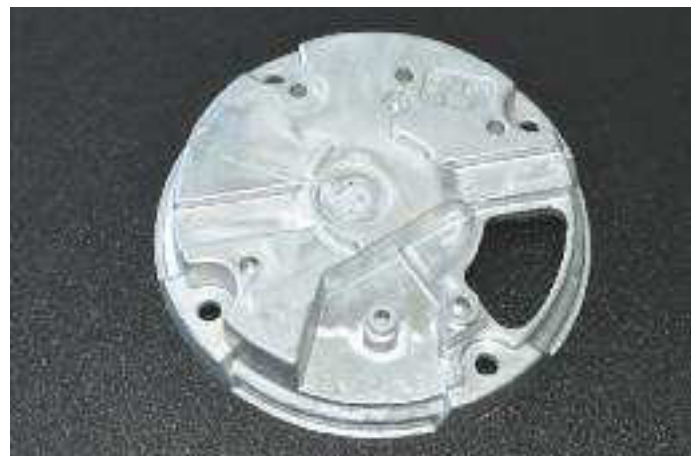
Abb. 2: Flansch als Motorabdeckung zur effizienten Gestaltung des Luftstroms, gegossen mit neu entwickelter Heißkanaldüse für Zinkdruckguss. Einsparung von 100.000 kg Zink/Jahr [Föhl]
