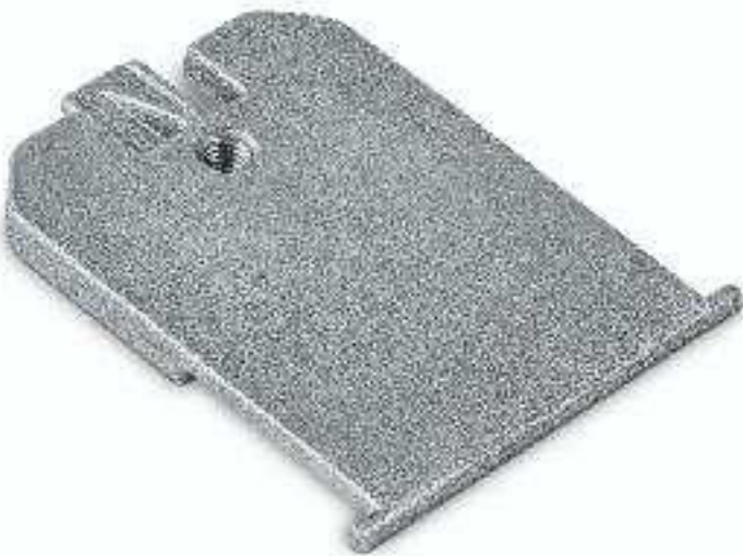
Abb. 1: Gehäuseklappe: Durch den serienmäßigen Einsatz eines Heißkanalsystems (FGS) wurden erhebliche Energieeinsparungen realisiert sowie die Taktzeit nahezu halbiert und in Summe die Wirtschaftlichkeit des Verfahrens deutlich gesteigert. [Initiative Zink/Power-Cast Ortmann]
